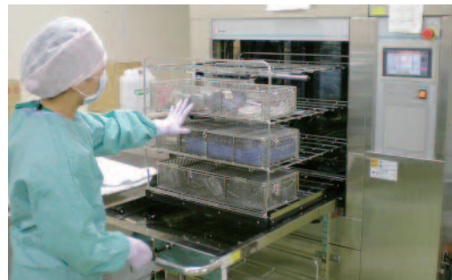
自動ジェット式超音波洗浄装置で洗浄します
